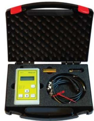
Simulationsbereich: 0,00 – 14,00 pH / -1550 – 1500 mV / 1 Mega-Ω Hochohmigkeit
